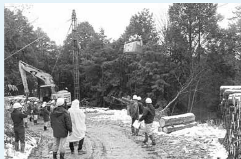
蘭国有林：ウッドライナーによる集材作業
