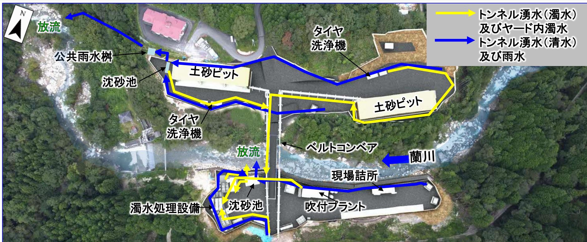
濁水処理のフロー図
